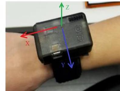
*L'x-IMU prodotto dalla x-IO technologies include un accelerometro triassiale a 12 bit, un giroscopio triassiale a 16 bit e un magnetometro triassiale a 12 bit (non utilizzato in questo lavoro). La frequenza di campionamento massima è 256 Sa/s.*
